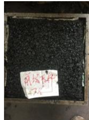
4) 室内拌合混合料成型 5) 拌合楼立即取料成型 6) 摊铺机位置取料 (拌后约 2h) 混合料性能试验步骤
