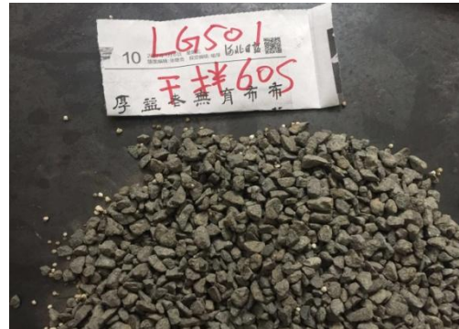
普通 SBS 拌合 1 分钟后完全未熔化
