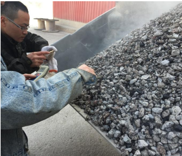
拌合楼 175℃干拌 5S 后放料观察：未找到未熔化的干法 SBS 改性剂颗粒，石料表面有熔融液膜包裹
