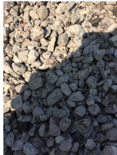
拌合楼 175℃干拌 5S 后放料观察：未找到未熔化的干法 SBS 改性剂颗粒，石料表面有熔融液膜包裹
