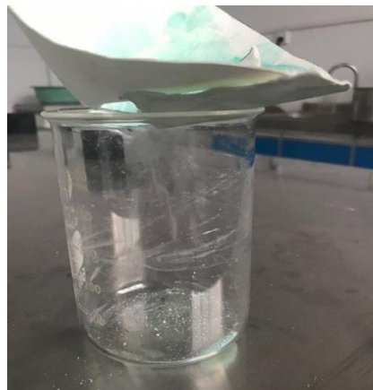
经过两次溶解和冲洗后基本不存在干法 SBS 微粒
