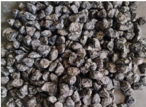
干法 SBS 拌合 1 分钟后成为液膜裹覆
