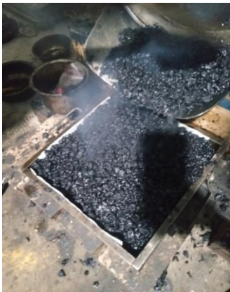
4) 室内拌合混合料成型 5) 拌合楼立即取料成型 6) 摊铺机位置取料 (拌后约 2h) 混合料性能试验步骤
