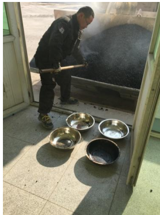
1) 干法 SBS 在拌合楼人工投放 2) 拌合楼取料试验 3) 摊铺机位置取料试验
